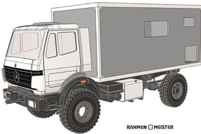
Abbildung 2: Das Expeditionsmobil, basierend auf einem Mercedes Benz 1831m, enthält 340 Schraubverbindungen. (Bild: Fast+More)
