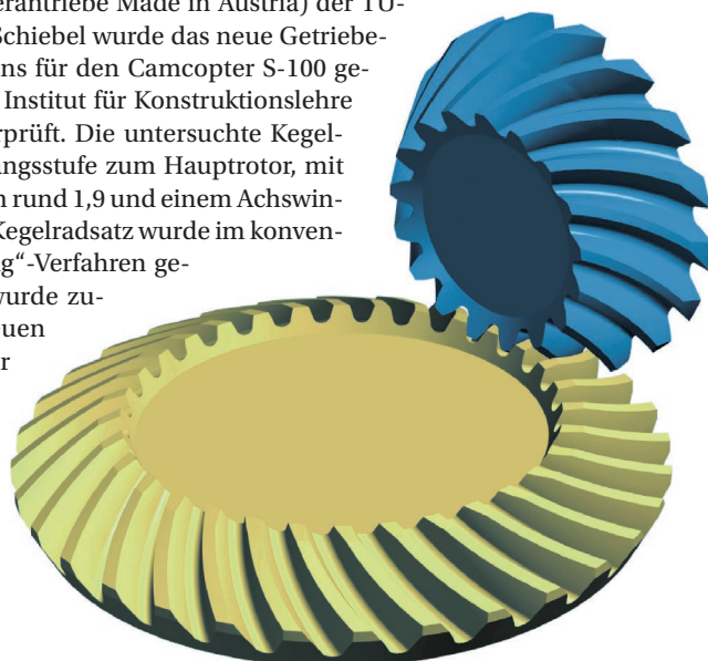
01 Kegelradsatz der Ausgangsstufe des neuen Getriebes
