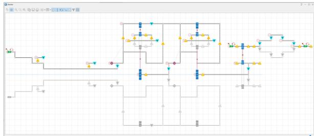
Le Sketcher permet de définir la topologie d'un engrenage de la même manière que si l'on utilisait un stylo et du papier. Le système est dessiné dans un quadrillage à l'aide de la souris et du clavier.
