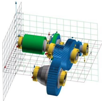
La déformation du système est visualisée. Cela permet de comprendre les principaux facteurs qui causent des déplacements dans l'engrenage, par ex. le fléchissement des arbres, des paliers ou des corps de roue.
