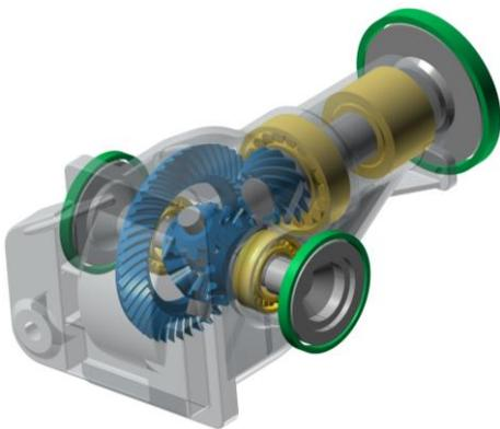
Quels que soient la topologie définie dans le Sketcher ou dans l'arborescence du modèle, et les détails de roue dentée et d'arbre construits, l'affichage 3D permet de vérifier rapidement l'arrangement et l'utilisation de l'espace de construction.
