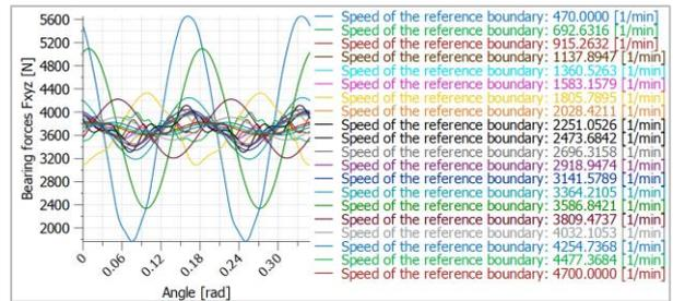
Dans l'analyse des vibrations forcées, l'excitation résultant de l'erreur de transmission est prise en compte en relation avec tous les engrenements, les déséquilibres de l'arbre et les ondulations du couple. Les bruits de carter peuvent être calculés à l'aide des forces de palier en fonction du temps.
