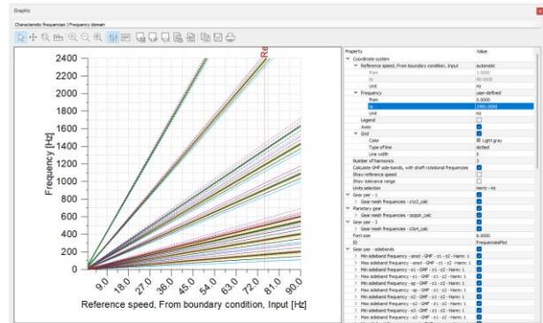
Lors de la détection d'erreurs, la connaissance des fréquences de roue dentée et de palier permet d'éviter les défaillances ou de planifier les opérations de maintenance. Les fréquences sont calculées en tenant compte des harmoniques et des bandes latérales sur une plage de vitesse de rotation.
