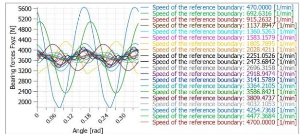
Nell'analisi delle risposte forzate, l'eccitazione derivante dall'errore di trasmissione viene considerata in relazione a tutti gli ingranamenti, gli sbilanciamenti degli alberi e i ripple di coppia. La rumorosità della scatola può essere calcolata attraverso le forze cuscinetto in funzione del tempo.
