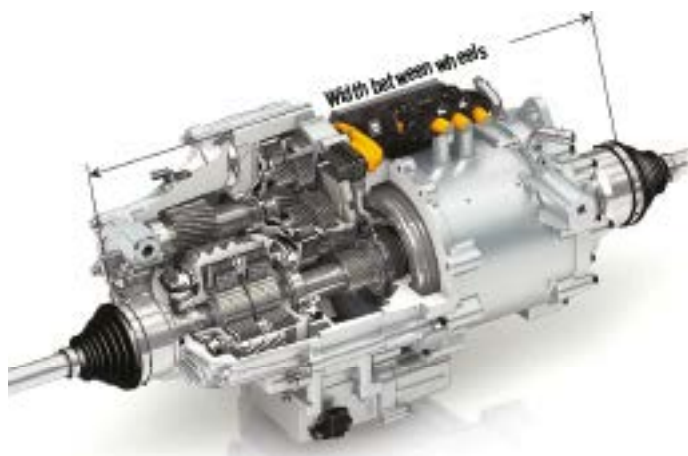
Fig. 1 - Motore elettrico in linea con la trasmissione (fonte: [1]).
