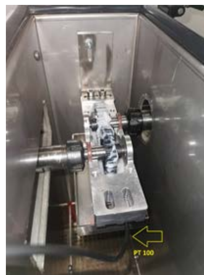
Figura 3. Sonda PT 100 inserita per misurare la temperatura del grasso
