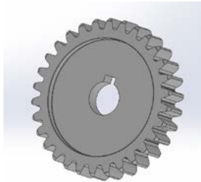
Figura 10. Risultato della scansione ottica (.step file)
